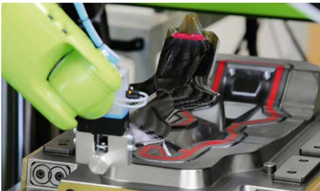
**Bild 11.** Automatisierte Entnahme des fertigen Bauteils aus dem Werkzeug (© Hennecke)
