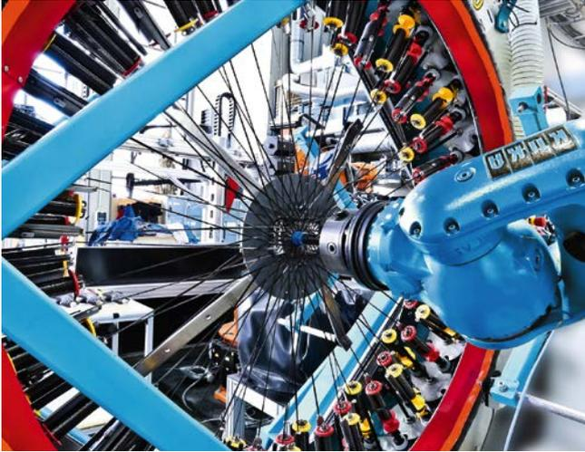
**Bild 7.** Automatisiertes Beflechten des Kerns im Radialflechter
