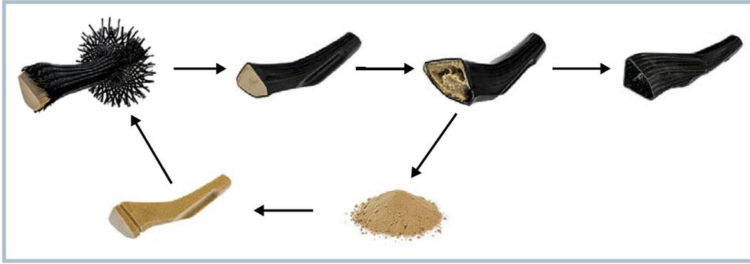
**Bild 2.** Cavus-Produktionszyklus (im Uhrzeigersinn von links): Der (z. B. additiv gefertigte) Sandkern wird mit Kohlenstofffasern beflochten und im Werkzeug im HP-RTM-Verfahren infiltriert. Nach dem Aushärten lässt sich der Kern mit Wasser herauslösen (© KTM Technologies)
