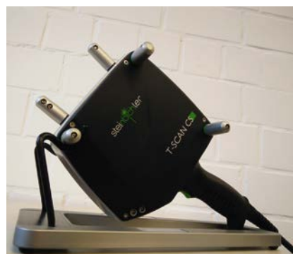
Bild 2. Mobiles optisches Messsystem, bestehend aus einem handgeführten Laserscanner (links) und einem Photogrammetrie-System (rechts). Damit erfolgt die Positionierungs- und Orientierungsbestimmung im Raum (© WZL)
