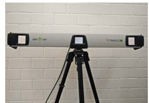
Bild 2. Mobiles optisches Messsystem, bestehend aus einem handgeführten Laserscanner (links) und einem Photogrammetrie-System (rechts). Damit erfolgt die Positionierungs- und Orientierungsbestimmung im Raum (© WZL)
