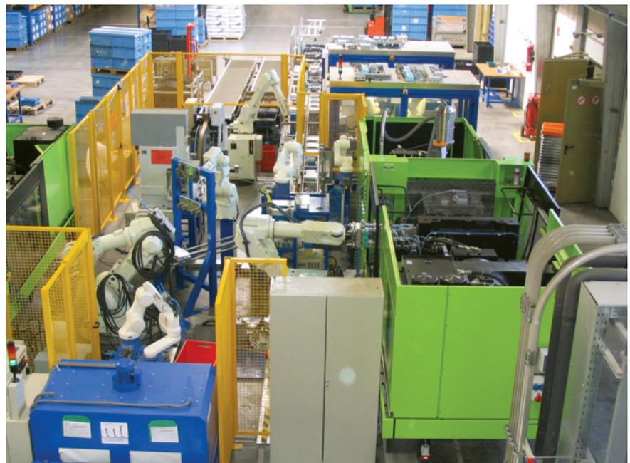
**Bild 1. Großserien-Fertigungslinie für Elektrokomponententräger eines Türschlossgehäuses der Automobilindustrie. Quarder verfügt über neun verschiedene Fertigungsvarianten. Geplant ist eine Jahresstückzahl von 2,9 Millionen, hergestellt auf vier roboterbestückten Produktionslinien**
