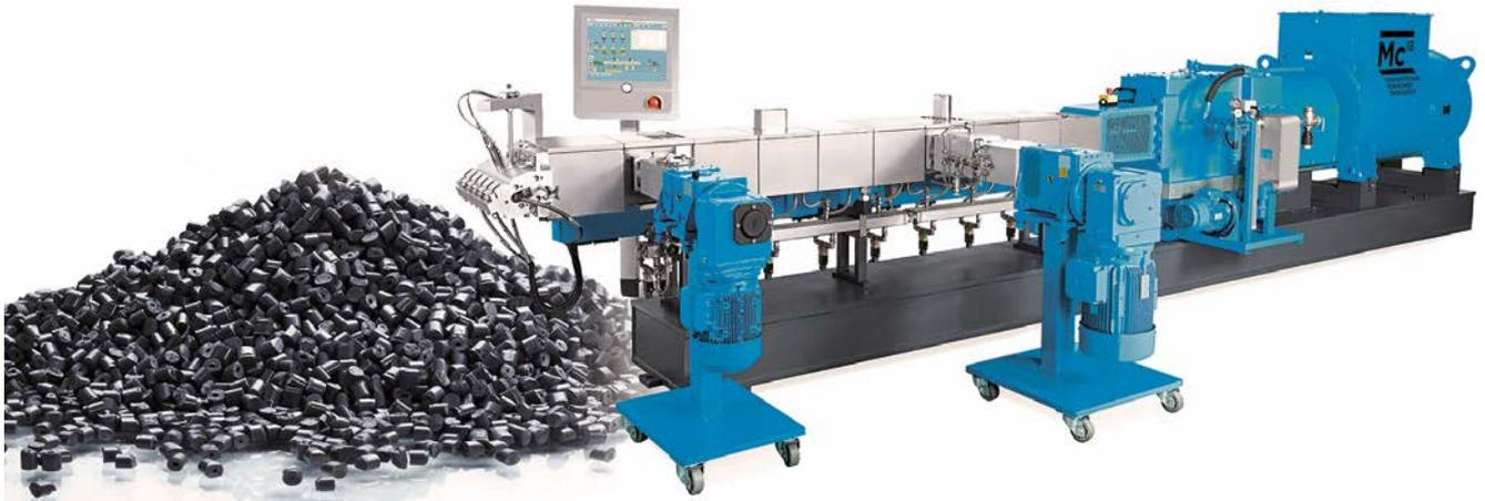
Mit einem Durchmesser Verhältnis der Schnecken von  $D_a/D_i = 1,55$  und einem spezifischen Drehmoment von  $18 \text{ Nm/cm}^3$  bietet der Doppelschneckenknetzer ZSK Mc<sup>18</sup> sehr gute Prozessbedingungen für die Masterbatchherstellung (Bilder: Coperion)
