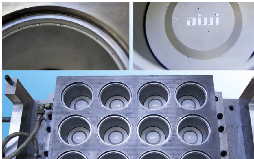
Becherwerkzeug mit Abluftbohrungen am Becherrand (Ausschnitt oben links) und am Becherboden (oben rechts) (Bilder: Illig)
