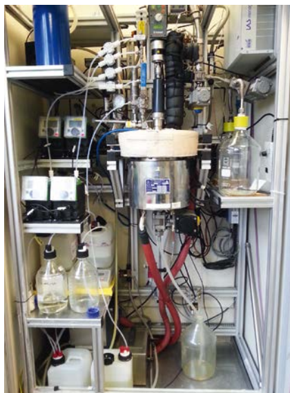
Bild 1. Um größere TBAMS-Mengen für weiterführende Untersuchungen bereitzustellen, wurde die Synthese optimiert und eine Versuchsanlage konzipiert
