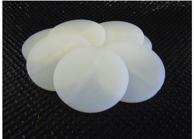
Bild 2. Spritzgegossener thermoplastischer Prüfkörper: Die Compounds lassen sich mittels gängiger Verfahren weiterverarbeiten
