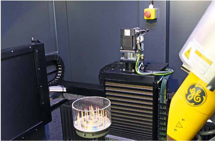
Bild 2. Metrotom-Check bei der Fähigkeitsfeststellung des v tome x m 300. Dabei werden in 25 Messungen die Abstände zwischen den kleinen Kugeln im Rundbehälter gemessen (© ProPlas)
