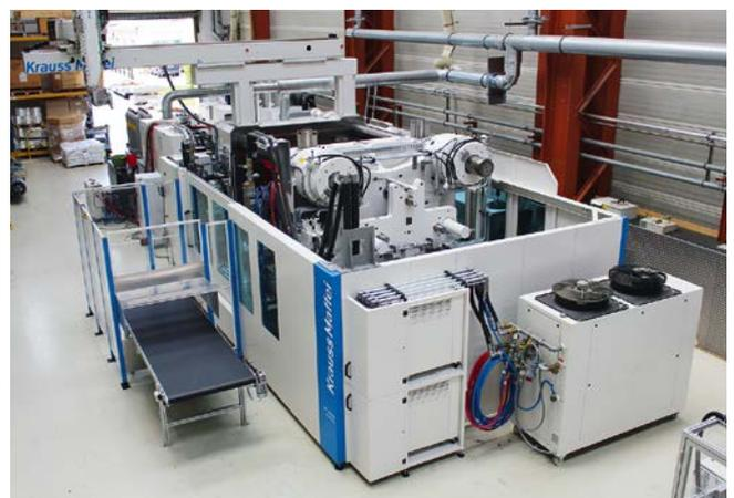
**Bild 3.** Mit der komplett von KraussMaffei installierten Produktionszelle ließ sich das Demonstratorbauteil mit einer Zykluszeit von weniger als 60 s herstellen (© KraussMaffei)
