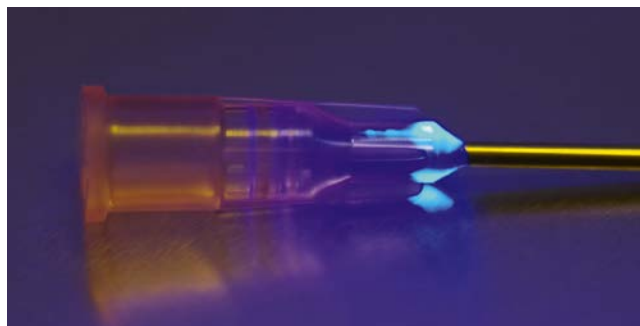
Bild 1. Miniaturspalt ausgefüllt: Eine mit dem niedrigviskosen Klebstoff verklebte medizinische Nadel
