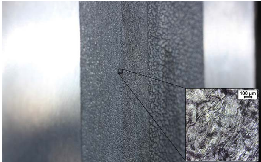
Typische Oberflächendefekte auf einem PMMA-Probekörper mit vier Oberflächenstrukturierungen (© IKV)
