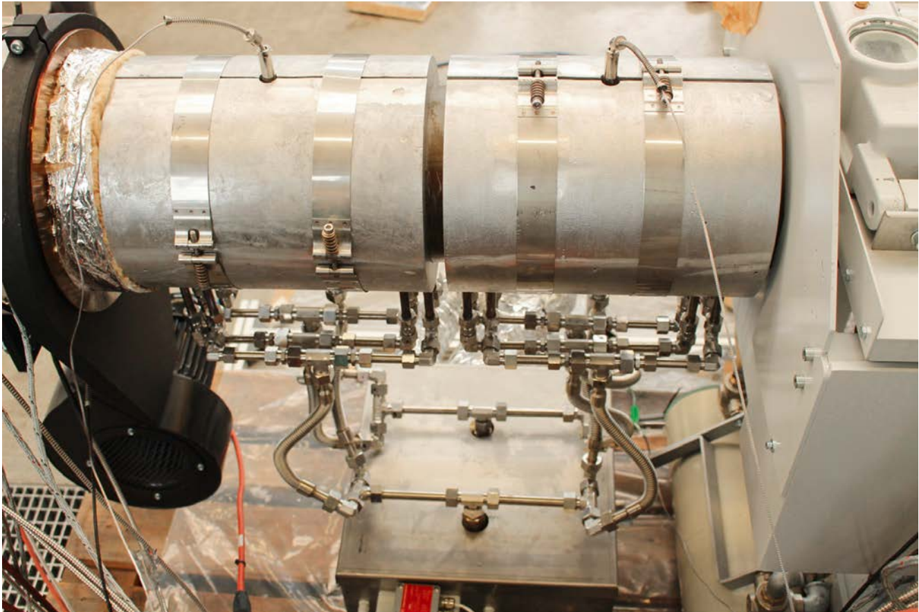
Prototyp einer Thermoöltemperiervorrichtung im Einsatz (© Universität Kassel)
