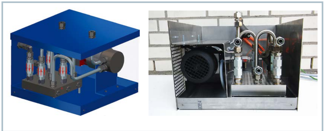
Bild 2. Temperiereinheiten: CAD-Konstruktion (links), Prototyp (rechts)
