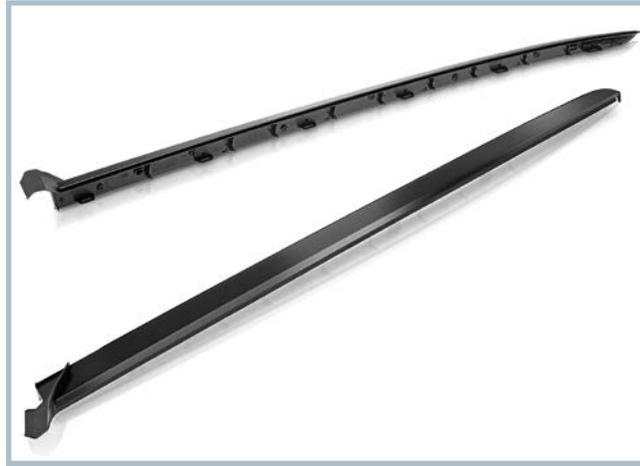
**Bild 8.** Türzierleiste, hergestellt im Color-Form-Verfahren. Der thermoplastische Grundkörper wird mit einem 2K-PUR-Lack überflutet
