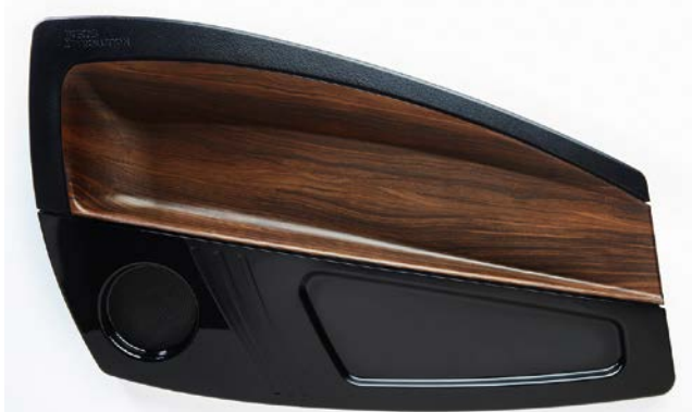
Bild 2. Endlosfaserverstärktes Composite-Bauteil, hergestellt aus einem thermoplastischen Organoblech auf Basis einer styrolbasierten SAN-Matrix (© Ineos Styrolution Group)
