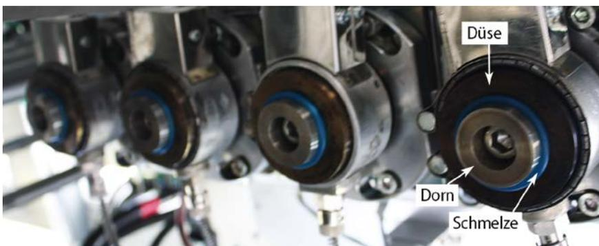
**Bild 4.** In einen Vierfachkopf integrierte GWDS-Düsen mit 40 mm Durchmesser. Die zylindrischen und am Ende profilierten Dorne sind hier aus der Düse herausgefahren worden, da die Profilierung für den Abschnitt des Bauteils nicht benötigt wird (© H. Groß)
