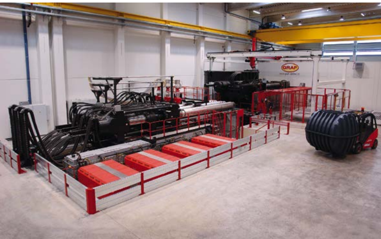
Die eigenen Angaben zufolge größte Spritzgießmaschine der Welt mit 55 000 kN Schließkraft steht bei Otto Graf und produziert Tankhälften © Otto Graf
