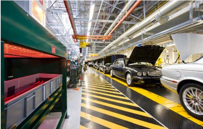
**Bild 1.** Jaguar-Produktion: Heckspoiler und weitere dekorative Heckelemente werden nach dem Vorwärmen an die Karosserie geklebt
