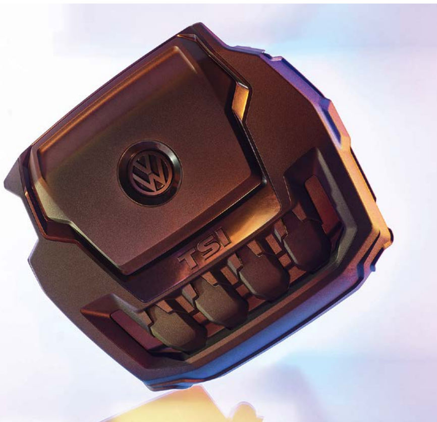
Anhand einer Motorabdeckung wurde gezeigt, dass das glasfaserverstärkte PP-Compound Hostacom ERG 393F mit dem Serienmaterial PA technisch und optisch mithalten kann. Außerdem ist es günstiger und energieeffizienter in der Verarbeitung (© LyondellBasell)
