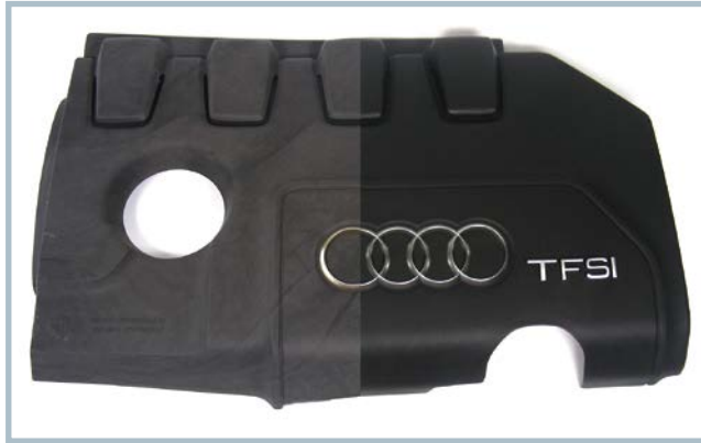
Bild 2. Die Motor-designhaube aus nicht-optimiertem PP-Compound im Anlieferungszustand (rechts) zeigt eine deutliche Degradierung des Polymers nach 500h Wärmealterung (links)
