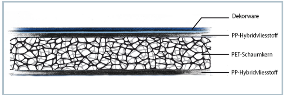
Bild 1. Materialaufbau von Mikrosandwich-Verbundsystemen bestehend aus PP-Vliesstoff und einem PET-Schaumkern inklusive Dekoration (© Daimler)
