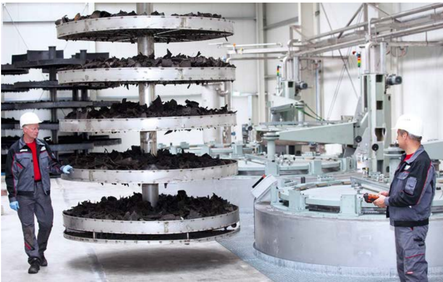
Einblick in die Produktion von recyceltem Industrieruß. Das Material aus Altreifen kommt grob geschreddert in der Produktion an und durchläuft dann den Pyrolyse-Prozess (Bilder: cct)
