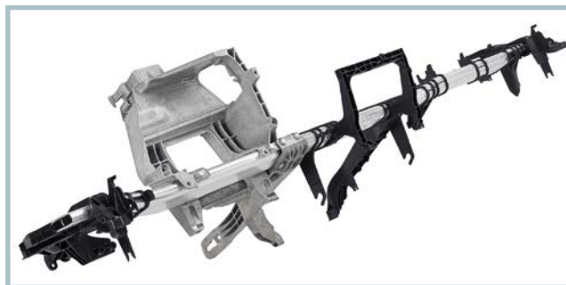
Bild 1. Herstellung von Strukturbauteilen aus Polymer-Metall-Hybriden: Das Kombi-Werkzeug vereint Innenhochdruck-Umformen und Kunststoffspritzgießen in einem Prozessschritt (Quelle: ElingKlinger)
