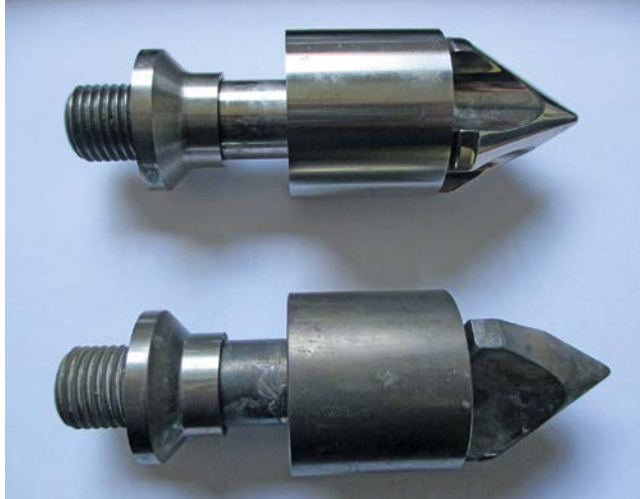
Bild 3. Bilder der Rückströmsperre nach 5000 Zyklen im Test. Oben mit dem Technyl One-Werkstoff, unten mit einem Standard-Polyphthalamid
