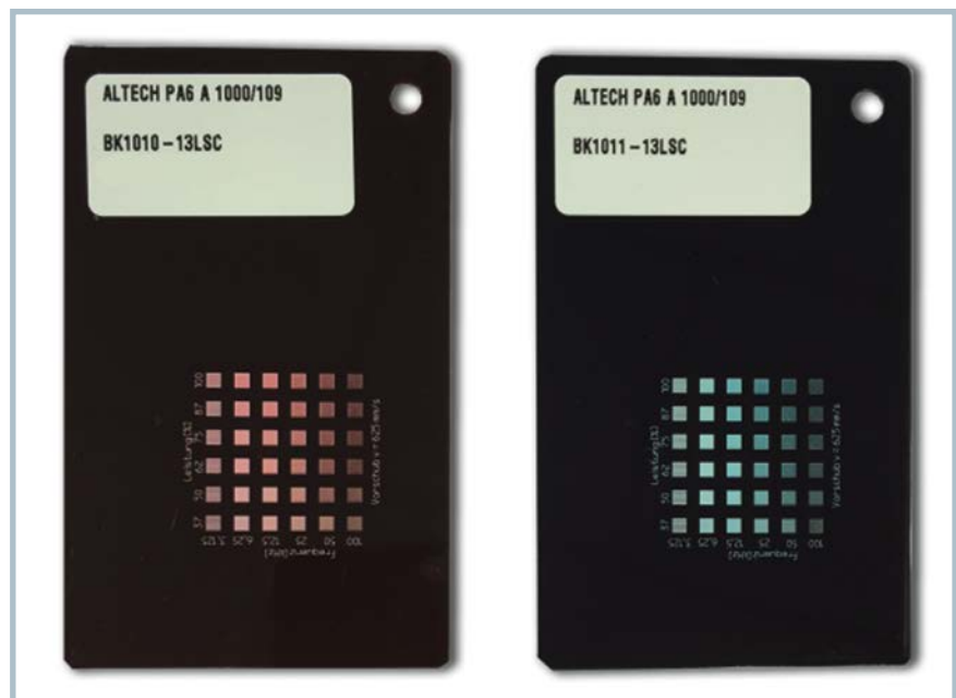
Farbige Lasermarkierung auf schwarz eingefärbten LSC-Compounds (© Albis)
