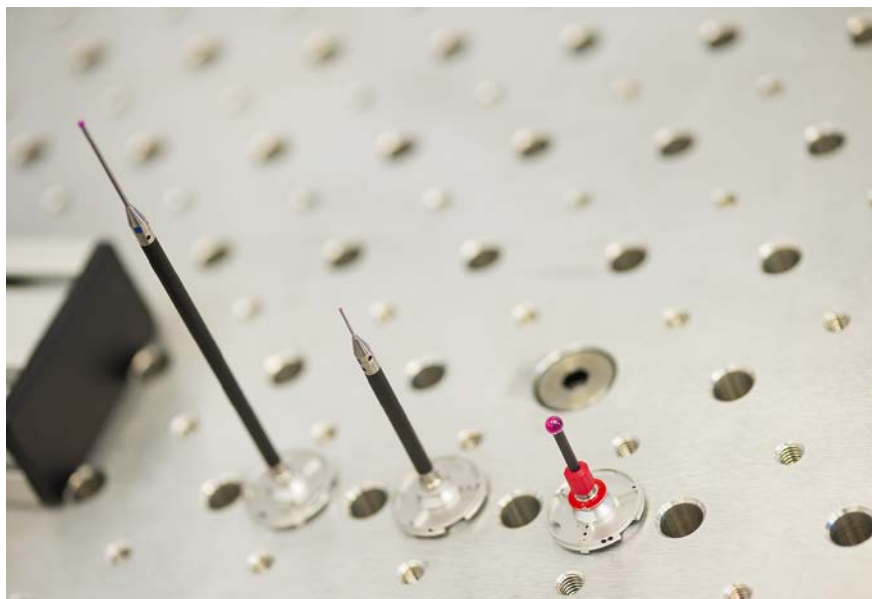
Wechselbare Sensoren: Auf dem Multisensormessgerät Accura können bis zu drei optische sowie sechs taktile (s. o.) Sensoren zum Einsatz kommen (© Zeiss)
