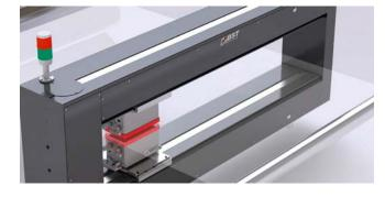
Isotopen-Durchstrahlsensor: Die radiometrische Lösung erlaubt berührungsloses Messen von Materialdicken auf 0,3 µm genau (© BST ProControl)
