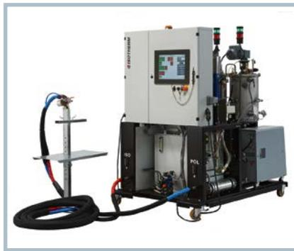
fen können stufenlos einstellbare Mischungsverhältnisse von 1:4 bis 4:1 realisieren. Die Austragsmengen variieren von 10 bis 60 g/s und sind somit besonders geeignet für die Herstellung von technischen Teilen mit kleinen Schussgewichten um 2 g oder für
