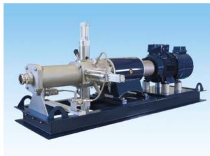
**Bild 6.** Dynamischer Mahr-Mischkopf für Polyurethan-Gießanwendungen (© Mahr)
