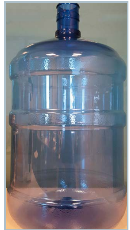
Bild 3. Die großen Mehrwegbehälter für die Wasserspender werden derzeit aus Polycarbonat hergestellt. Aufgrund der Bisphenol-A-Problematik soll hier zukünftig PET als Ersatzmaterial eingesetzt werden
