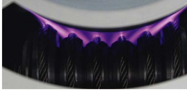
Bild 2. Die Aerosole werden von unten auf die Folie aufgebracht. Das hat den Vorteil, dass die funktionellen Moleküle sehr dünn und gleichmäßig verankert werden können (© kalwar)
