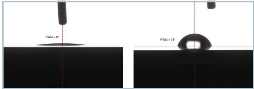
Bild 4. Die Kontaktwinkelmessung einer mit (links) und ohne (rechts) Calvasol beschichteten Folie zeigt den Einfluss der Calvasol-Antifog-Funktion: Ziel ist eine maximale, hydrophile Oberfläche zu schaffen, die sich bei der Messung mit Wasser durch einen niedrigen Kontaktwinkel zeigt. Je höher der Kontaktwinkel (rechtes Bild) desto schlechter der Antifog-Effekt (© kalwar)
