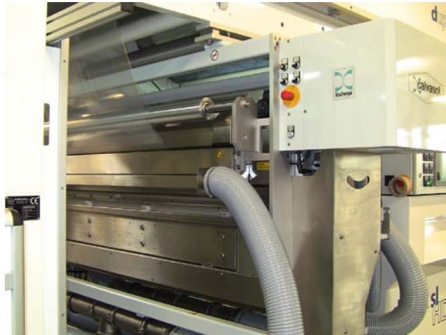
Bild 3. Die Calvasol-Anlage kann direkt in den Kaschierprozess integriert werden, ohne den Kaschierklebstoff negativ zu beeinflussen (© kalwar)
