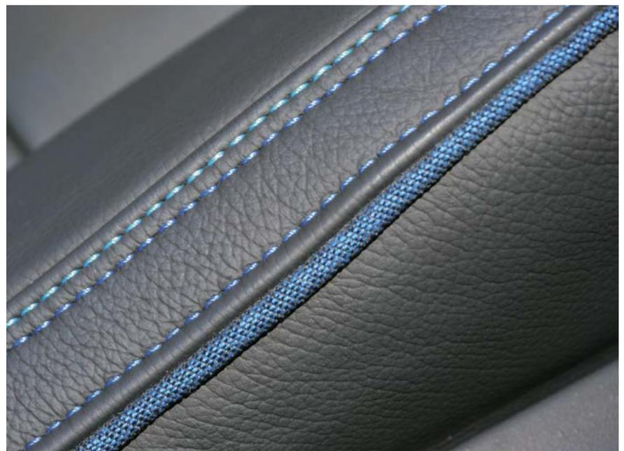
**Bild 2.** Sieht aus wie hohe Handwerkskunst, ist aber ausgefeilte Fertigungstechnik: Die kontrastierenden Nahtverläufe am Fahrzeugsitz entsprechen dem Kundenwunsch nach „Craftsmanship“, genauer gesagt nach visuellen und haptischen Highlights selbst im kleinsten Detail (© J. Friedrich)
