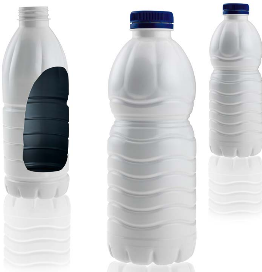
Die Milchflasche besteht aus zwei Schichten PET: einer weißen Außenhaut, die das Auge des Käufers anspricht, und einer grauen, lichtundurchlässigen Innenwand zum Schutz der Milch (© Netstal)
