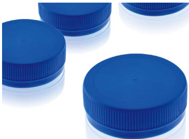
Bild 4. Pro Stunde entstehen in einem 32-fach-Werkzeug rund 29 000 Single-Piece-Verschlüsse mit 38 mm Durchmesser und einem Teilegewicht von 2,8 g (© Netstal)
