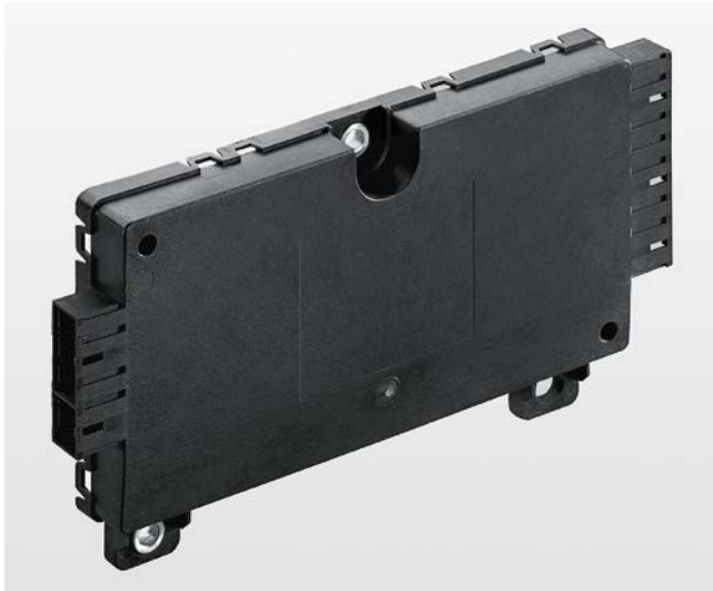
Bild 1. Das Gehäuse für die Batteriemanagementeinheit aus dem PBT-ASA-Blend ist sehr flach und kompakt. Das Bauteil hat die Aufgabe, den Hochspannungsstromsensor und die Isolationsüberwachungseinheit in der Batterie von Elektro- und Hybridfahrzeugen zu steuern (© Hella)
