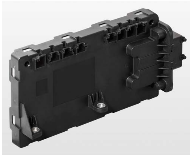
Bild 2. In das Gehäuse für die Zellenüberwachungseinheit sind Funktionen wie etwa Kontaktstifte integriert, weshalb es vor allem im Randbereich geometrisch sehr komplex ist. Der Werkstoff muss verzugsarm sein und gleichmäßig schwinden (© Hella)
