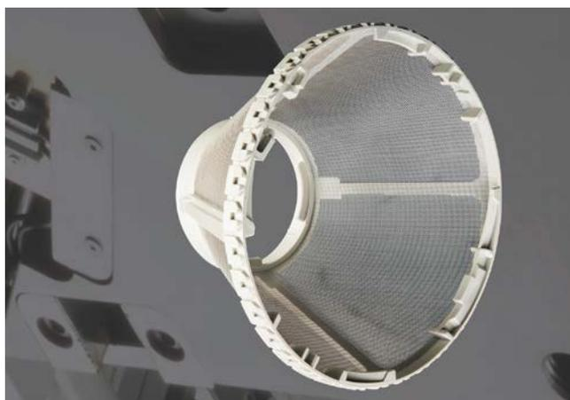
**Bild 2.** Trichterförmiges Mikrofeinfilter-sieb einer Geschirrspülmaschine. Das Edelstahlgewebe wird im Werkzeug vorgeformt und anschließend umspritzt (© Synventive/EKT)
