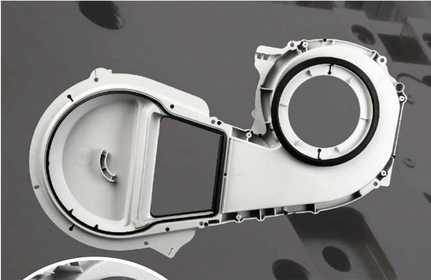
**Bild 3.** 2K-Luftführung für einen Wäschetrockner. Bypässe in der Hartkomponente sorgen dafür, dass die Weichkomponente (Dichtung) gleichzeitig auf beiden Seiten des Bauteils angespritzt werden kann (© Synventive/EKT)
