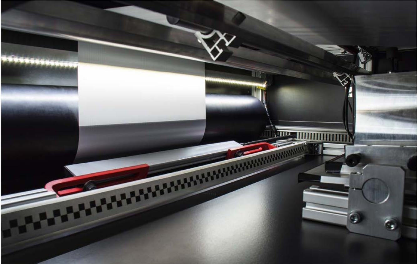
oWTP-Messprinzip: Um Aussagen über die Planlage machen zu können, ermittelt der optische Web-Tension-Profile-Scanner (oWTP-Scanner) die Bahnkraftverteilung (web-tension profile) an einer vorübergehend elektrostatisch aufgeladenen Folienbahn, indem ein Bildverarbeitungssystem die an einer Gummiwalze entstehende Abrollkante analysiert (© IVV)
