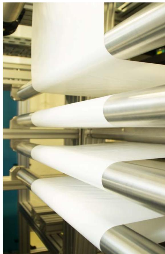
**Bild 2.** Der Bahnlaufversuchsstand für die Untersuchung von Materialeigenschaften und -belastungen bei Verarbeitungsgeschwindigkeiten von 120 m/min (© IVV)
