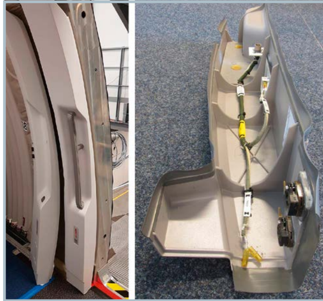
Bild 5. Demonstrator einer Türinnenverkleidung: Das vom CTC Stade und Partnern entwickelte Hybrid-SMC mit fließfähigen SMC-Außenschichten und versteifenden, vorimprägnierten Endlosfaserverstärkungen ermöglicht komplexe Luftfahrtbauteile (© CTC GmbH)
