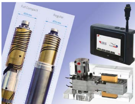
Bild 7. Platz sparende Full Compact Nozzles (links), externes Smart Interface (rechts oben) zur Programmierung der servoangetriebenen Flexflow One; Druckplatten, die, zwischen Heißkanalsystem und Werkzeug eingefügt, das Temperaturprofil vergleichmäßigen (rechts unten) (© HRSflow)
