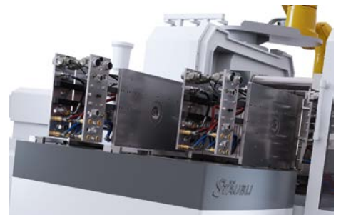
Bild 3. In einer Spritzgießfertigungszelle werden Werkzeugschnellwechselsystem plus Handlingsystem vorgeführt (© Stäubli)
