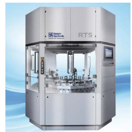
Bild 5. Das schnelltaktende Ringtransfersystem ermöglicht eine schnelle Montage auf kleinem Bauraum (© teamtechnik)
