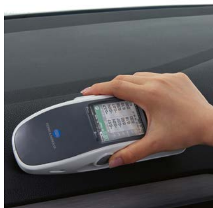
Bild 6. Messung von Glanz und Farbe mit dem CM-25cG auf einer texturierten Oberfläche
