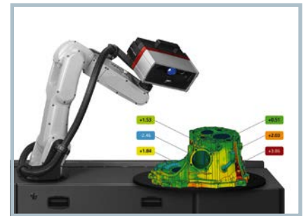
Bild 5. Vermessung einer Gehäuseglocke mit Atos Capsule (© GOM)
