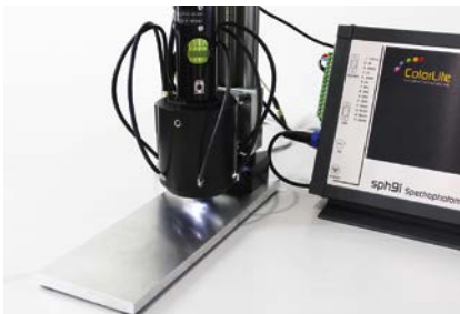
Bild 8. Mikroskop-Spektralphotometer: Ein Farbmessgerät für extrem kleine Flächen (© ColorLite)
