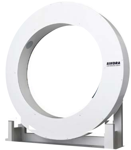
Bild 2. Online-Inspektion und Sortierung von Kunststoffmaterial: Im Inneren wirken eine Röntgenkamera und eine optische Kamera zusammen (© Sikora)
