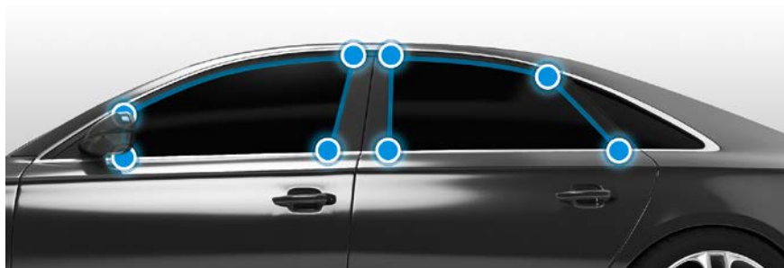
Bild 6. Kraiburg zeigt ein TPE mit sehr guter Haftung zu Ethylen-Propylen-Dien-Kautschuk (EPDM) beispielsweise für Automobil-Exterieur-Anwendungen, wie z. B. Fensterdichtungen
