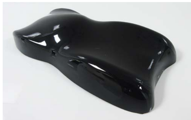
Bild 7. Die Senosan-Hard-Coat-Beschichtung kann inline nach der Extrusion von Plattenware appliziert werden und eignet sich auch in Piano-schwarz für dreidimensionale Exterieur-Bauteile
