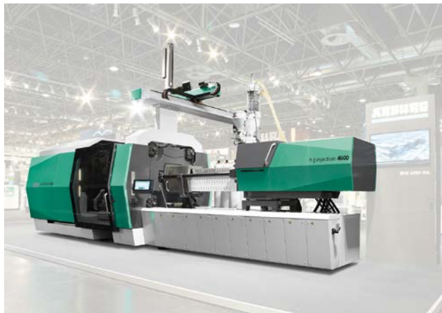
Bild 6. Arburgs neuer hybrider Allrounder 1120 H mit 6500 kN Schließkraft, verjüngtem Design und neuer Gestica-Steuerung (© Arburg)
