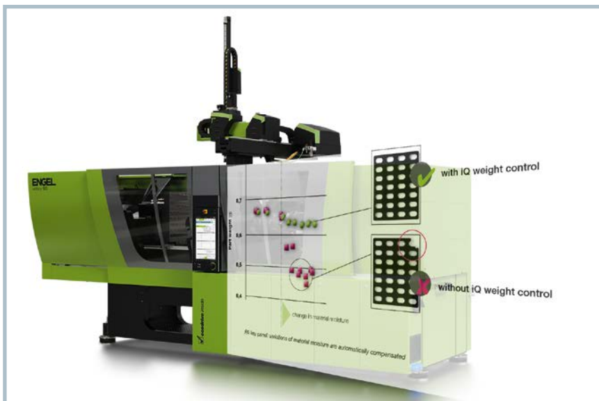
Bild 2. iQ weight control reduziert Schwankungen des Bauteilgewichts (© Engel)
