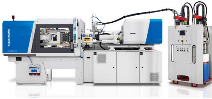
Bild 3. Auf einer PX 50-180 SilcoSet werden Fresnel-Linsen aus Flüssigsilikonkautschuk hergestellt (© KraussMaffei)
