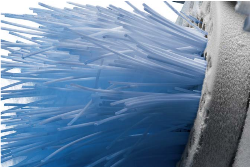
Trockeneis: Die extrudierten Stränge werden zu Granulat geschnitten und in der Düse des Strahlapplikators zu 1 bis 1,5mm großen Eispartikeln zerkleinert, bevor Druckluft sie auf Überschallgeschwindigkeit beschleunigt (© Cold Jet)
