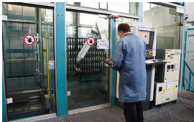
Einfache Trockeneisreinigung: Der bisher nur für die Beflammung genutzte Roboter wurde zusätzlich mit einer CO 2 -Versorgung und einem Strahlapplikator ausgestattet (© Cold Jet)
