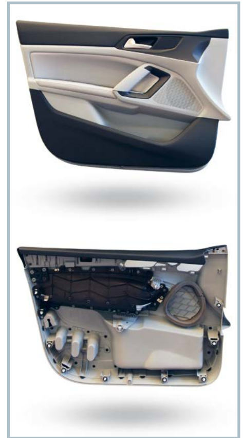
Bild 1. Bereits seit 2013 wird das Material in Serie zu Türbrüstungen und Türinsets des Peugeots 308 verarbeitet. Seit Juli dieses Jahres kommt es auch im Elektrofahrzeug Jaguar I-Pace zum Einsatz (© Faurecia)
