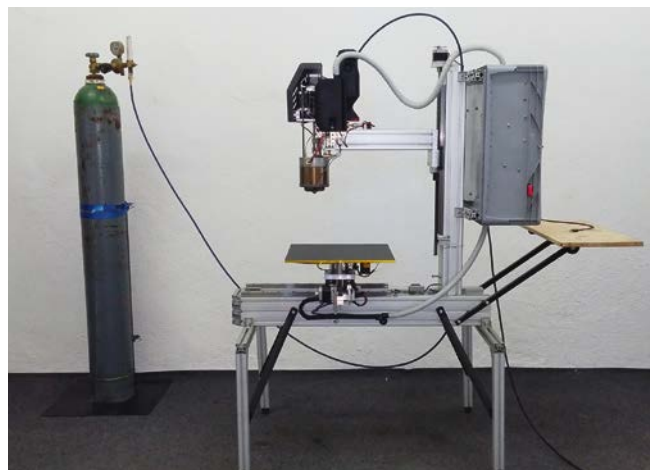
Bild 1. Der Prototyp des handelsübliches Granulat verarbeitenden 3D-Druckers. Schutzgas verhindert die Oxidation der Kunststoffschmelze (© Starfort)
