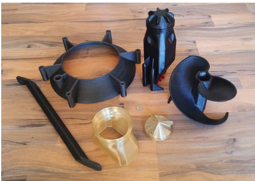
Bild 4. Musterteile aus dem Granulatdrucker, hergestellt aus (von den beiden transparenten Teilen im Uhrzeigersinn ausgehend) PSU, PC-CF15 (ebenfalls zwei Teile) sowie PC und PA6-GF27
