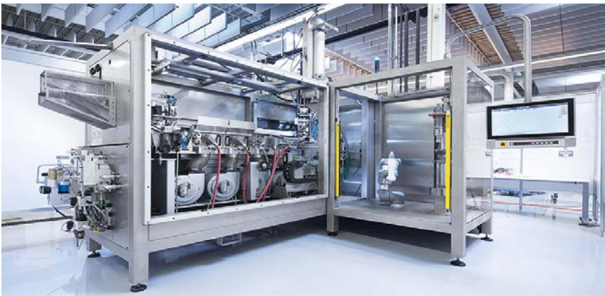
Einsparpotenziale: Die auf der Drinktec im „Technology Lab“ gezeigte FormFill-Maschine integriert die beiden bisher separaten Prozesse Füllen und Streckblasen (© KHS)
