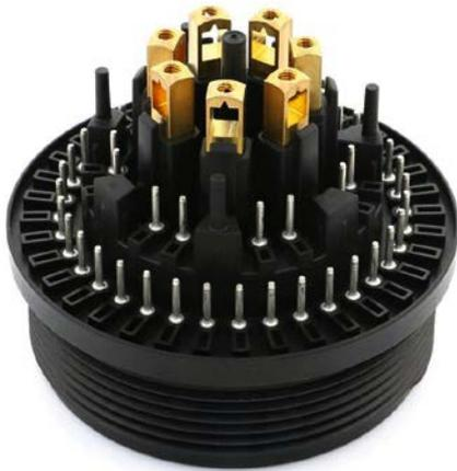
**Bild 5.** 57 Metallkontakte werden vor dem Umspritzen exakt im Werkzeug positioniert
