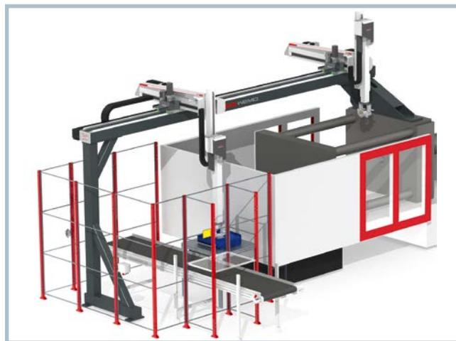
**Bild 4.** Das Wemo Tandem Concept beinhaltet zwei Roboter auf einer Linearachse (© Wemo Automation)
