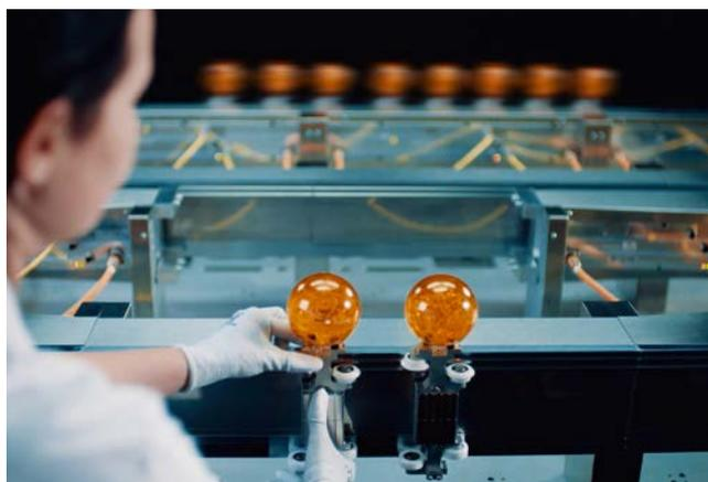
Bei einem Produktwechsel setzt der Bediener lediglich die Räder der gerüsteten Shuttles auf die Führungen. Auf den restlichen Linien des Tracks läuft die Produktion in voller Geschwindigkeit weiter (© B&R)
