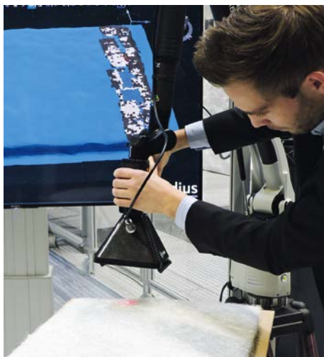
Bild 2. iComposite 4.0: Mit Bildverarbeitung lässt sich inline ermitteln, ob sich beim Ablegen der Fasern eine Vorzugsorientierung eingestellt hat und die Flächengewichte inhomogen verteilt sind, um durch das Platzieren von Endlosfasereinlegern korrigierend eingreifen zu können (© Hanser/K. Klotz)
