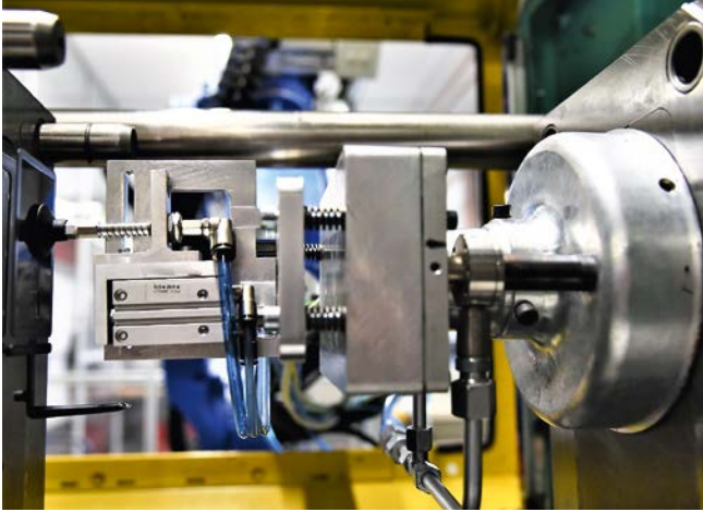
Bild 1. Im Serieneinsatz wird auf der Auswerferseite das fertige Teil entnommen, während parallel auf der Düsen­seite die Kavität aufgeheizt wird (links). Das 3D-gedruckte metallische Heizkopfmodul (rechts) ermöglicht eine schnelle Anpassung an kundenspezifische Geometrien im Werkzeug © Varioplast
