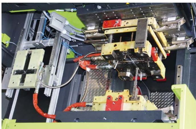
**Bild 4.** Herstellung der Substruktur im Spritzgießverfahren (© Fraunhofer ICT)
