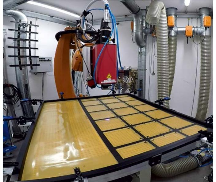
**Bild 2.** Die zusammengesetzten Gitterstrukturen wurden mittels Laserdurchstrahlschweißen mit der Deckschicht am Laser Zentrum Hannover verbunden (© LZH)
