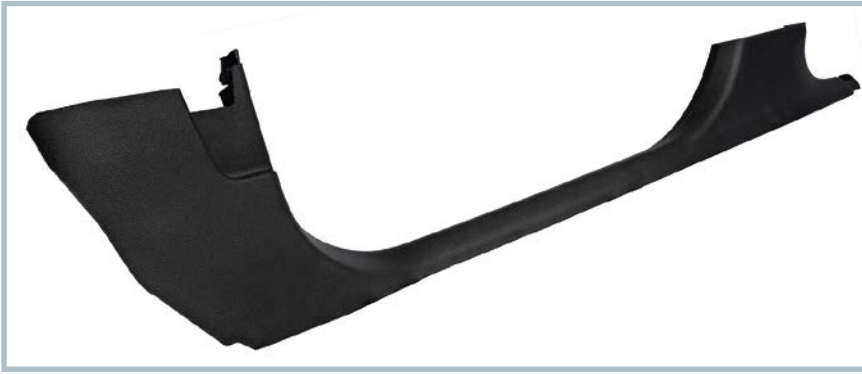
Bild 3. Prototyp einer PP-Einstiegsleiste, die durch Polyfort PPC MGB 6 RD rund 15% leichter ausfällt als die Talkum-gefüllte PP-Variante. Auch die gesteigerte Fließfähigkeit zahlt sich bei dem 1250 mm langen Bauteil aus (© A. Schulman)
