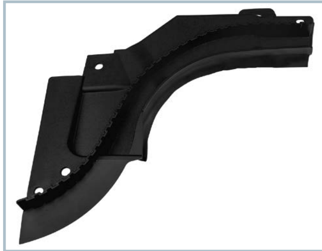
Bild 1. Die Schottwandabdeckung aus dem modifizierten Polyamid Schulamid RD6 GF30 fällt bei vergleichbaren Materialeigenschaften rund 9% leichter aus als der Vorgänger aus PA6-GF30. Das Compound zeigt darüber hinaus eine bessere Haftung zu TPE-Dichtungswerkstoffen (© A. Schulman)
