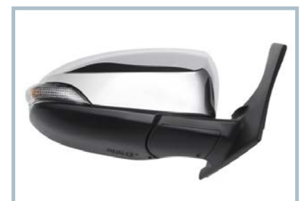
Bild 3. Die Türspiegelhalterung besteht aus dem unlackierten, spritzgegossenen PA Leona 90G. Der Werkstoff kann bei vergleichsweise niedrigerer Werkzeugtemperatur verarbeitet werden (© Asahi Kasei)
