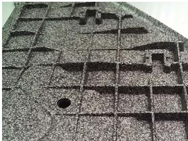
Bild 7. Das modifizierte Polyphenylenether (m-PPE) Sunforce wird in Form von Schaumperlen verarbeitet. Es ähnelt EPP, hat jedoch zusätzlich eine V-0-Flammschutzklassifizierung und gute Formbeständigkeit (© Asahi Kasei)
