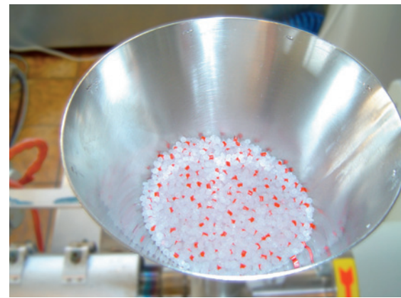
Bild 2. Druckfiltertest nach EN 13900-5: Über den Druckanstieg einer definierten Menge bei der Extrusion kann auf die Dispergierung der Pigmente und auf Verunreinigungen durch Grobpartikel, Agglomerate oder Rußanteile geschlossen werden
