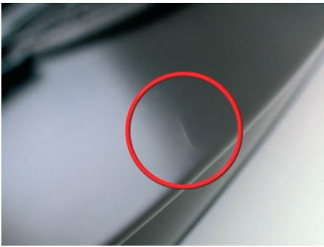
Bild 3. Sporadisch auftretender Weißbruch am Formteil ohne automatische Kühlzeitberechnung
